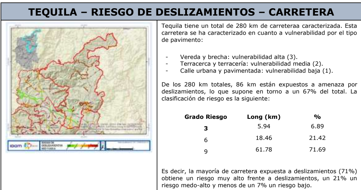
Figura 15. Riesgo de deslizamiento en carretera
