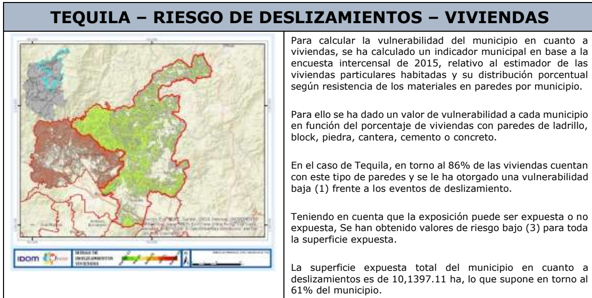
Figura 12. Riesgo de deslizamientos en viviendas
