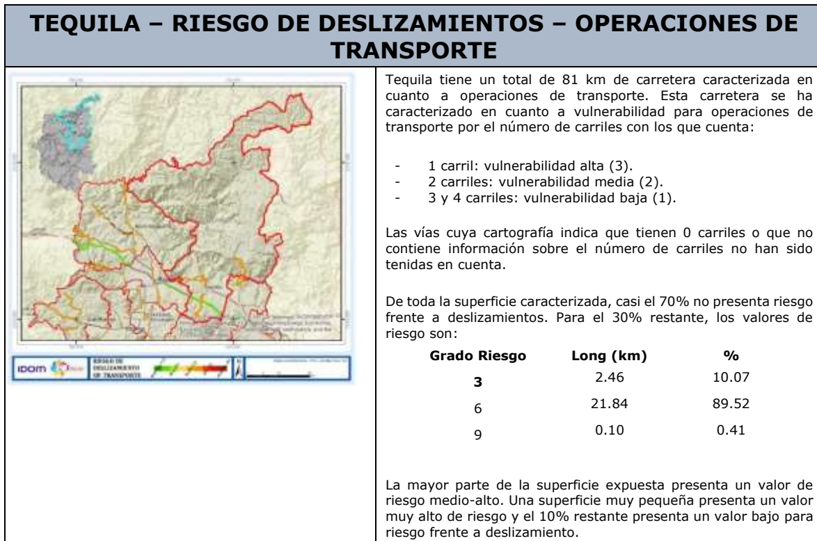
Figura 16. Riesgo de deslizamiento en operaciones de transporte
