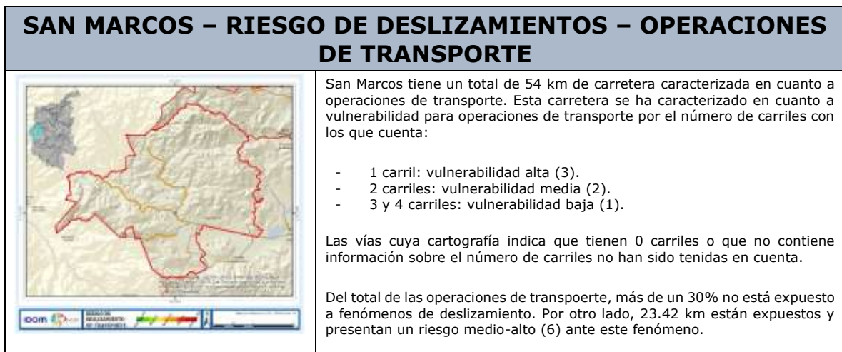
Figura 12. Riesgo de deslizamiento en operaciones de transporte
