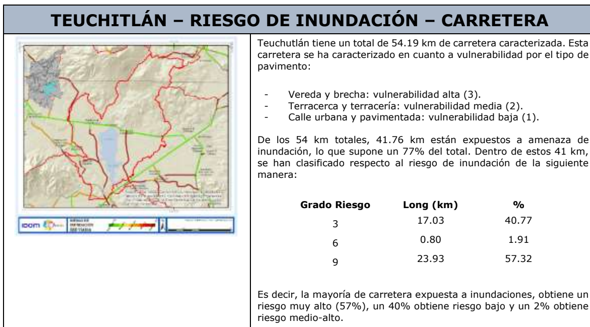
Figura 12. Riesgo de inundación en carreteras
